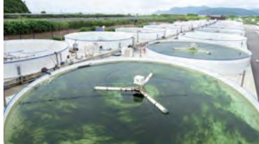
24基の大型水槽では水流でスジアオノリを攪拌しながら育てる
