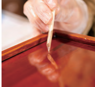
孔雀の羽根でできた道具で不純物を取り出す
